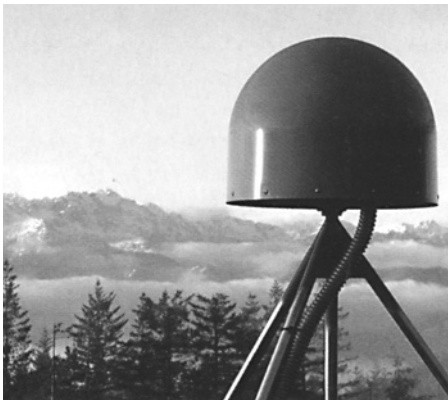
«Тихие землетрясения» можно обнаружить с помощью системы спутниковой навигации. На фотографии: станция GPS в штате Вашингтон (США)
